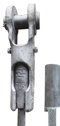
Attacco rapido testa fusa Efficienza applicazione: 100% del MBF fune
