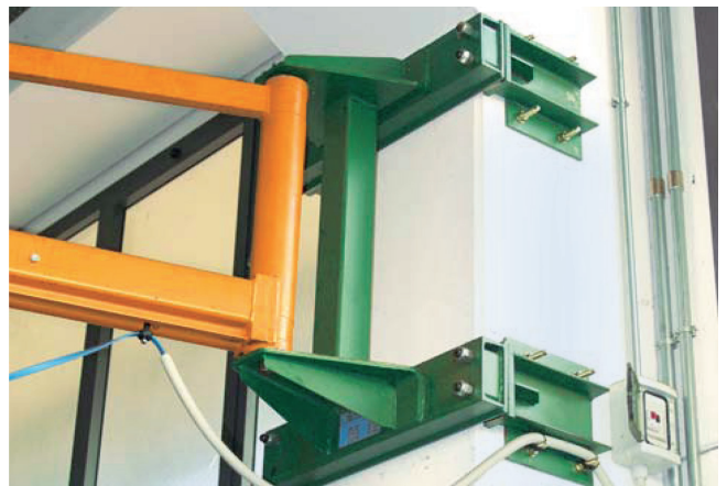
Imbragatura mediante tasselli chimici. Chemical bolts anchoring.
