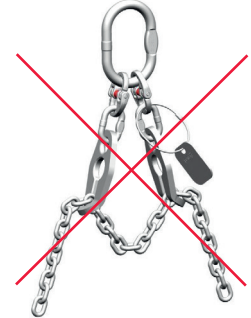
Applicazione sbagliata Wrong application
