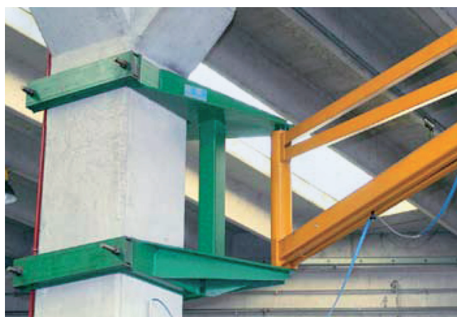
Imbragatura su spigolo. Edge anchoring.
